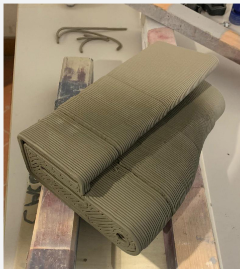
Stampa del modulo con stampante per fluidodensi Wasp Delta 2040
