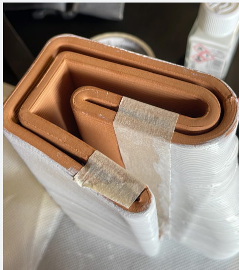
Fotografie del modulo durante la stampa, l'essiccazione e l'invitriatura
